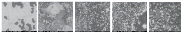
SEM. Superficie de policromía tras un proceso de limpieza en dos fases para la completa eliminación del graffiti: A4, B4, C4, F4y G4
